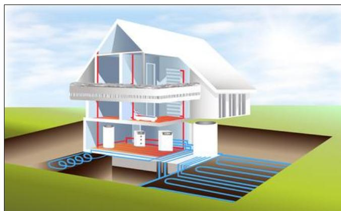
Bild 3: Kreislauf in neuem Wohnhaus mit Wärme aus dem Erdreich.
